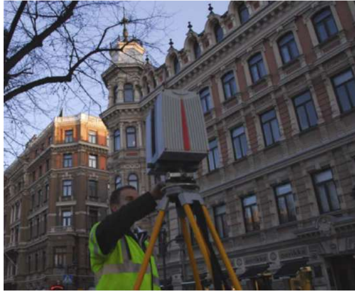
Grönqvistin talon Esplanadin puoleinen osa digitoitiin Leican valmistamalla maalaserkeilaimella. © FGI ja Aalto-yliopisto. Hannu Hyyppä.
