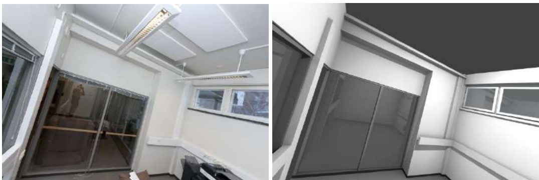
Kuva 3. Vasemmalla on referenssikuva ja oikealla on pintamallista laskettu synteettinen kuva, johon on liitetty materiaalit.
