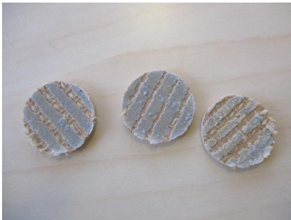
4.9 Linoleummaton liima-aineksessa ei havaittu merkkejä vaurioitumisesta
