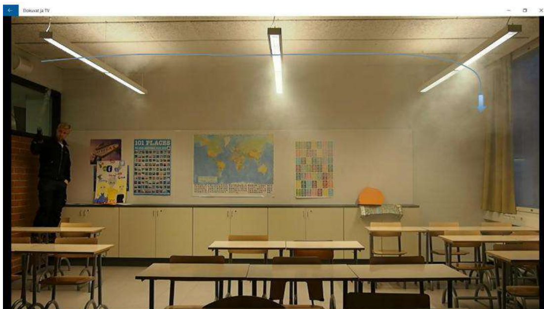
Kuva 14. Savukoe opetustilassa 145, ilmavirta 30 %, savutus 60 sek.
