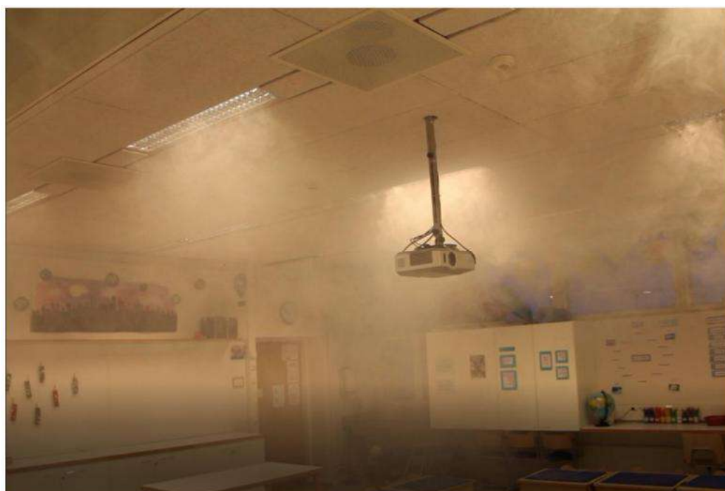
Kuva 15. Savukoe opetustilassa 2009, ilmavirta 100 %, savutus 50 sek.
