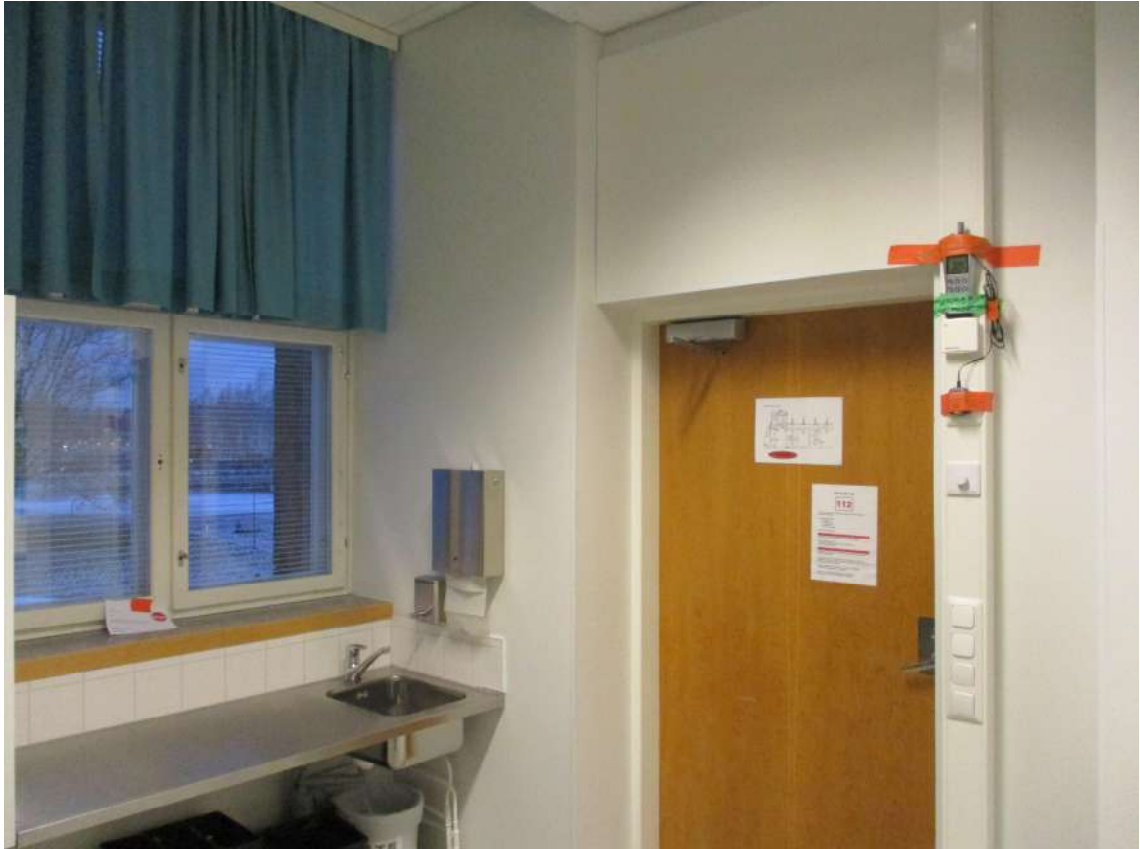
Kuva 5. Olosuhteiden (CO 2 , LT, RH) seurantamittaus rakennusautomaatiojärjestelmän oman anturin vierestä.
