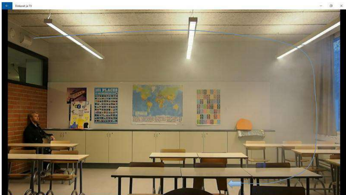
Kuva 13. Savukoe opetustilassa 145, ilmavirta 70 %, savutus 62 sek.
