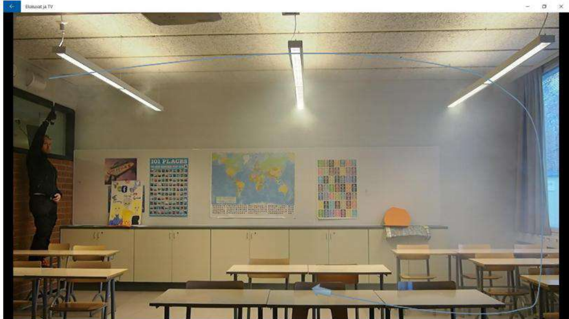
Kuva 12. Savukoe opetustilassa 145, ilmavirta 100 %, savutus 60 sek.
