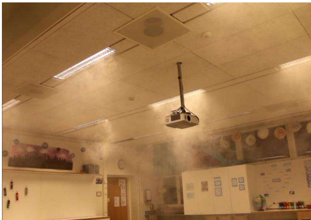
Kuva 15. Savukoe opetustilassa 2009, ilmavirta 100 %, savutus 50 sek.
